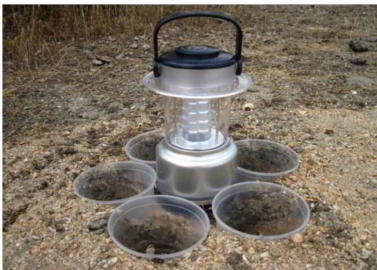
Рис. 3. Почвенные ловушки с источником света.
