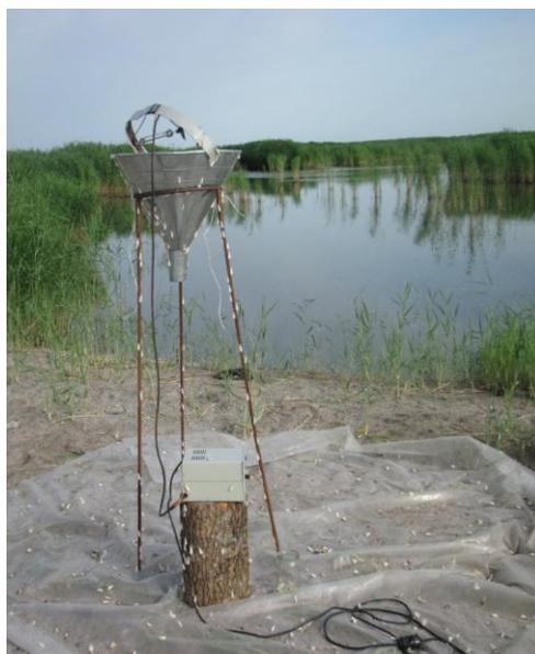
Рис.2. Световая ловушка с ртутно-кварцевыми излучателями
