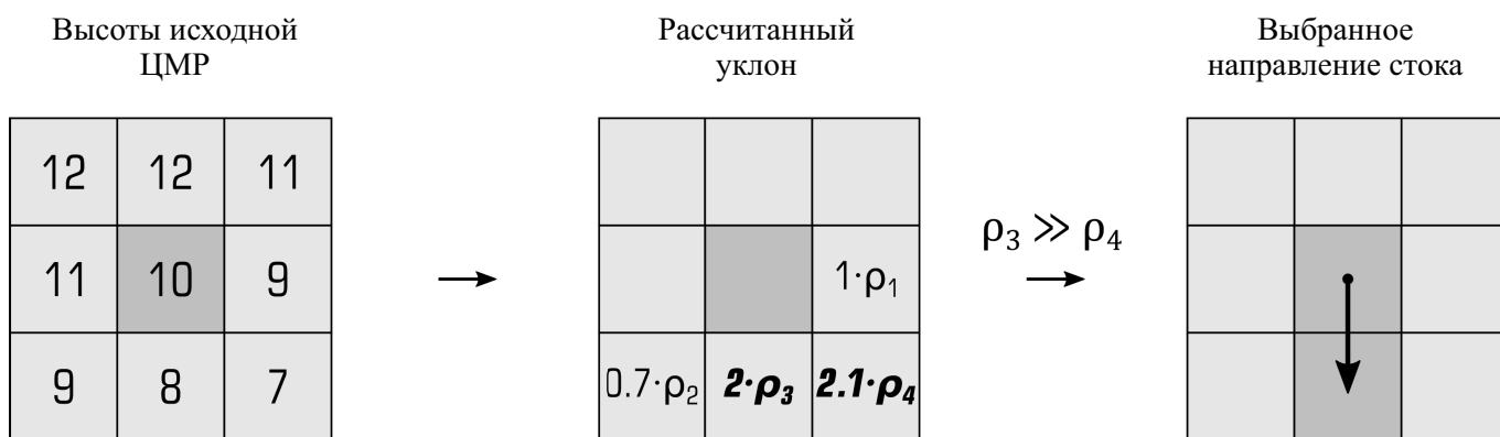
Рис. 3. Расчет направлений стока по алгоритму Rho8
