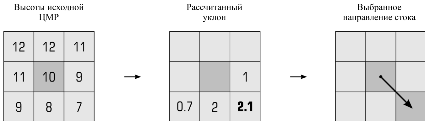
Рис. 2. Расчет направлений стока по алгоритму D8
