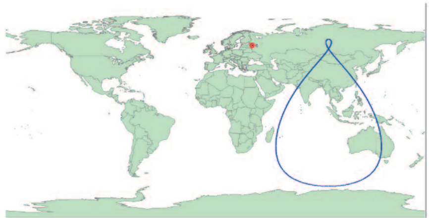
Рис. 9. Номинальная форма трасс подспутниковых точек для ОГ, состоящей из четырех КА (табл. 4)
