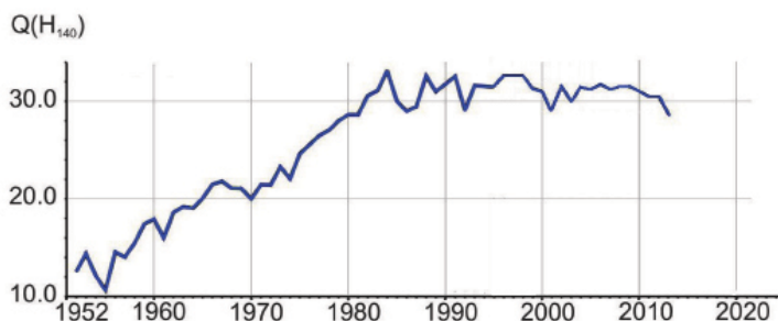
Рис. 11. Изменчивость расходов воды р. Полонети на гидростворе Яжелбицы за период 1952 – 2013 гг. при уровне воды 140 см над «0» поста.
