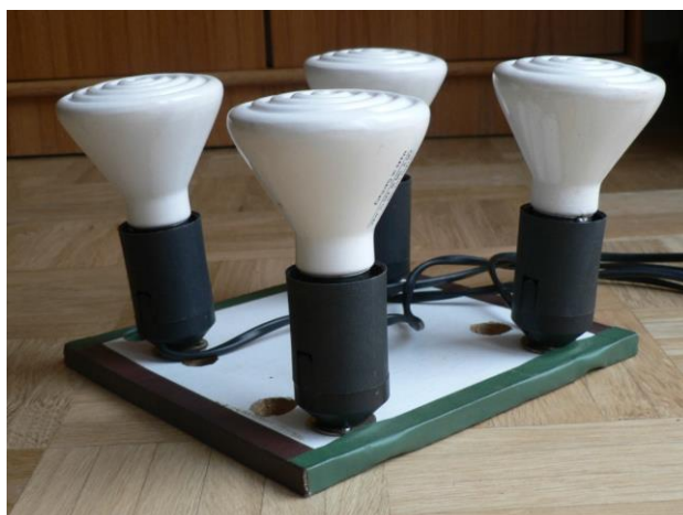
Поясняющий рисунок 3. Инфракрасные лампы мощностью 100 Вт (Elstein, тип IOT).
