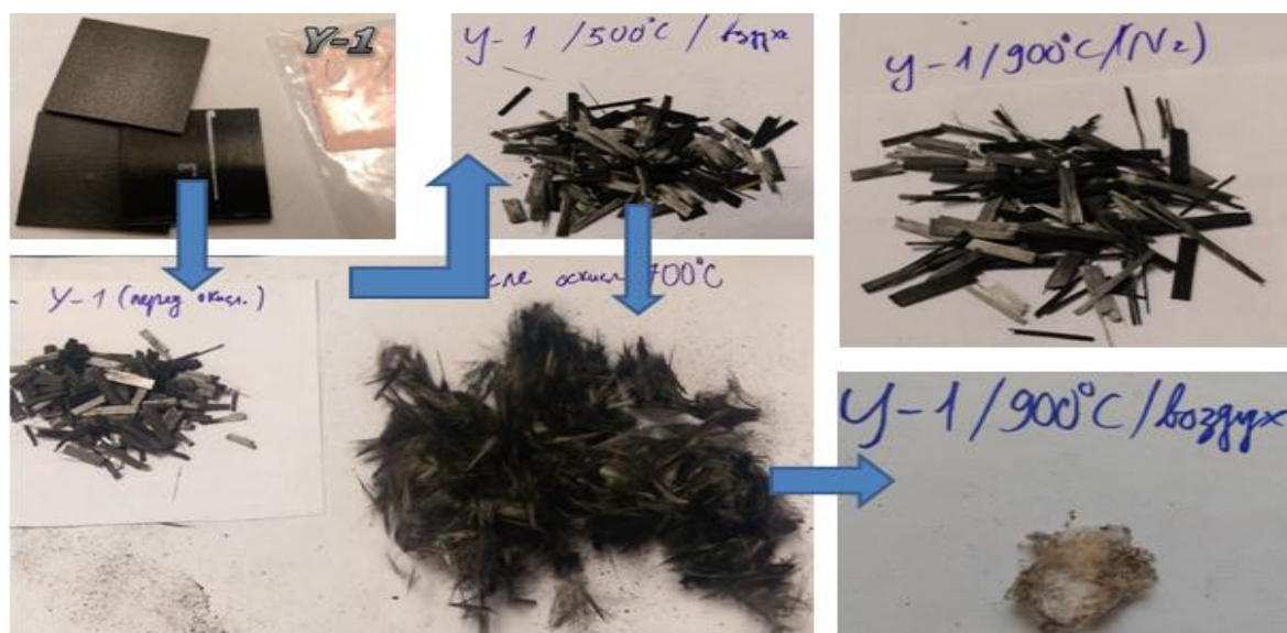
Рис. 1. Превращения образца углепластика при нагревании в воздухе и азоте
