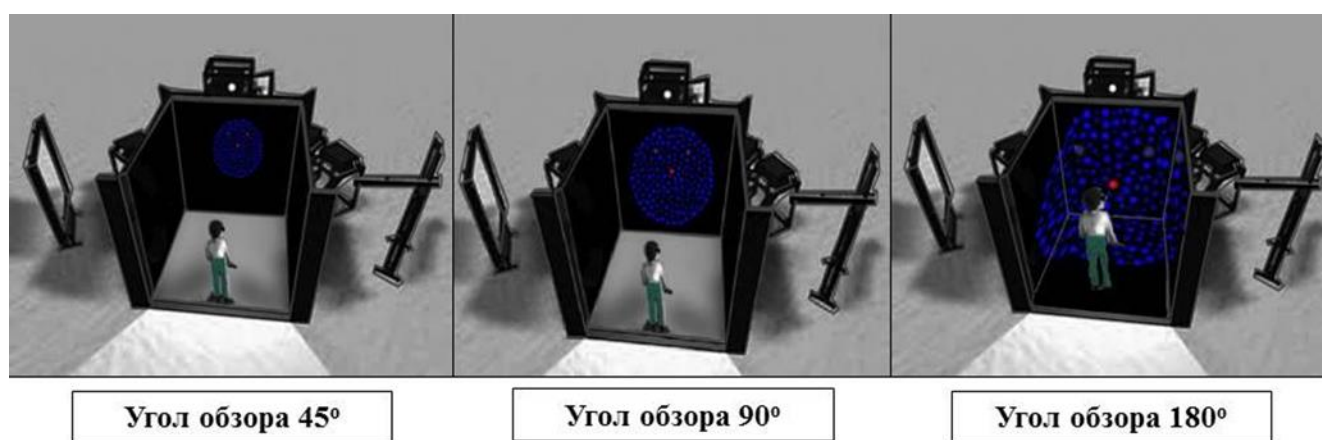
Рис. 1. Предъявление стимуляции в установке виртуальной реальности CAVE-system.
