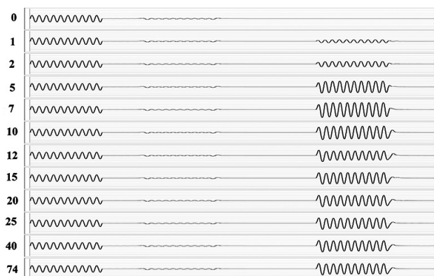
Рис. 3. Зависимости показаний приёмника от времени для всех исследуемых длин трещин, в мм.
