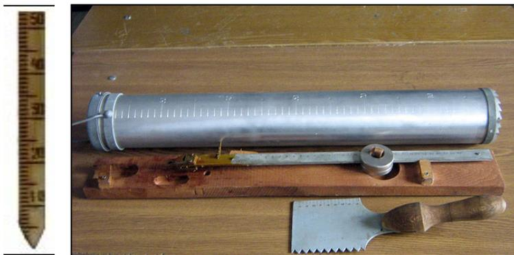
**Рис. 16.1.** Снегомерная рейка и весовой снегомер ВС-43.
