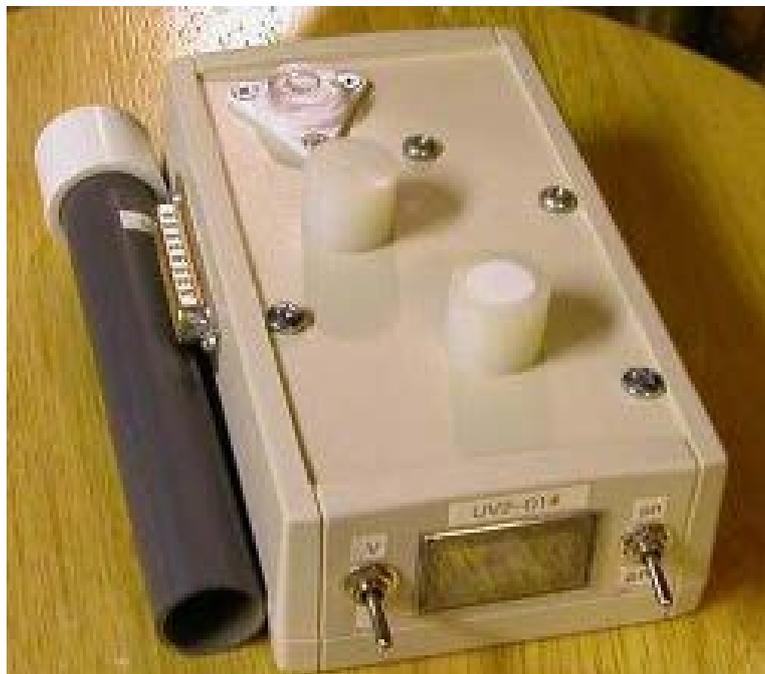
**Рис. 4.2.** Уфиметр GLOBE и трубка для измерения прямой радиации.
