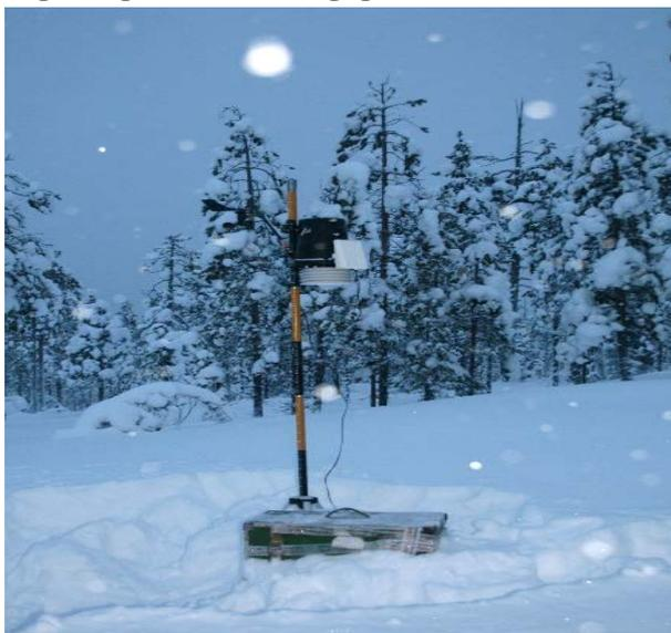
**Рис. 3.1.** Автоматическая метеорологическая станция Davis Vantage Pro, установленная на г. Ругозерской
