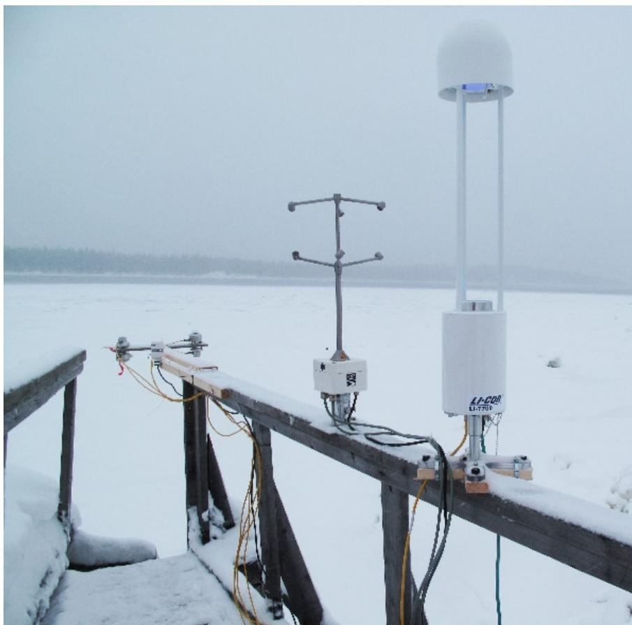
**Рис. 7.2.** Газоанализатор LI-7700, установленный на пирсе (правый прибор)
