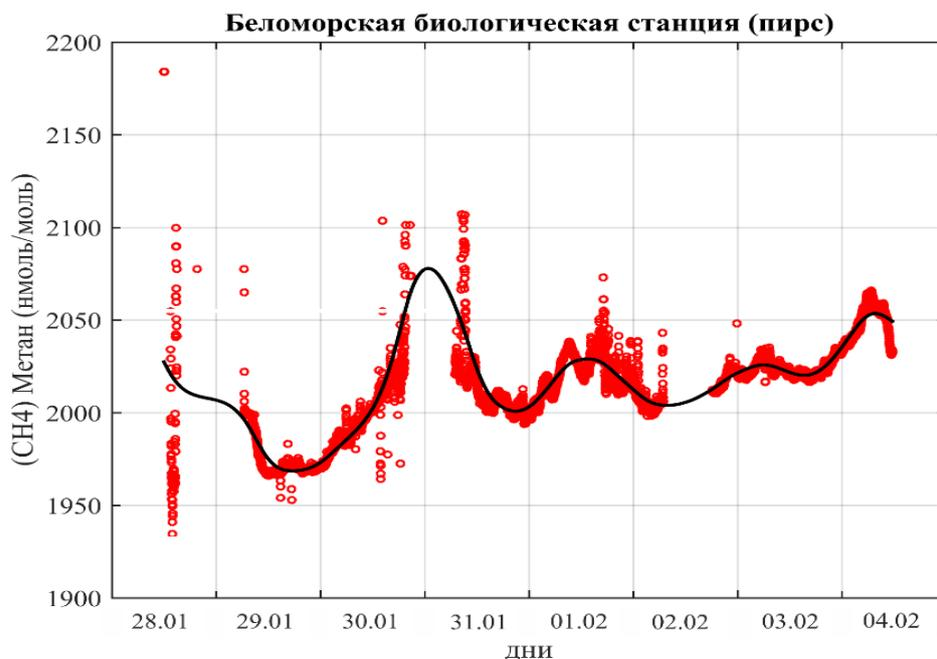
**Рис. 7.3.** Данные измерений концентрации метана на пирсе (красные точки, минутное осреднение), интерполяционная кривая (черная линия)
