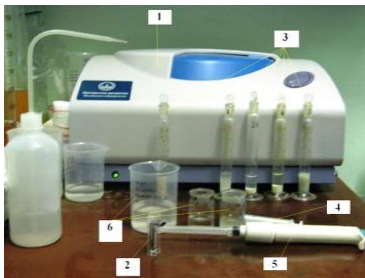
Рис. 2. Оборудование для определения \zeta -потенциала методом микроэлектрофореза: 1 – лазерный анализатор заряда и размера частиц Horiba SZ-100; 2 – ячейка для микроэлектрофореза; 3 – цилиндры с суспензиями исследуемых грунтов; 4 – шприц; 5 – микродозатор; 6 – бюксы и стаканчик для разбавления суспензии
