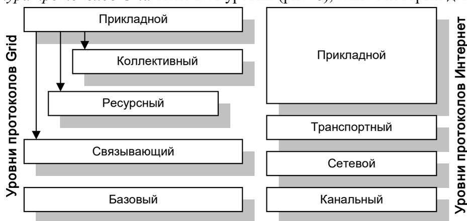
Рис. 8. Уровни архитектуры протоколов Grid и Интернет
