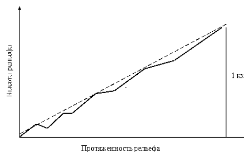
Рис. 2. Схема определения программой Map Info среднего наклона рельефа местности.
