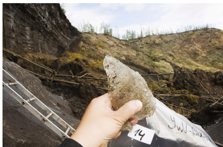
Рис. 11. Криоструктурные особенности жильного льда, вскрытого в нижней части Батагайской едомы
