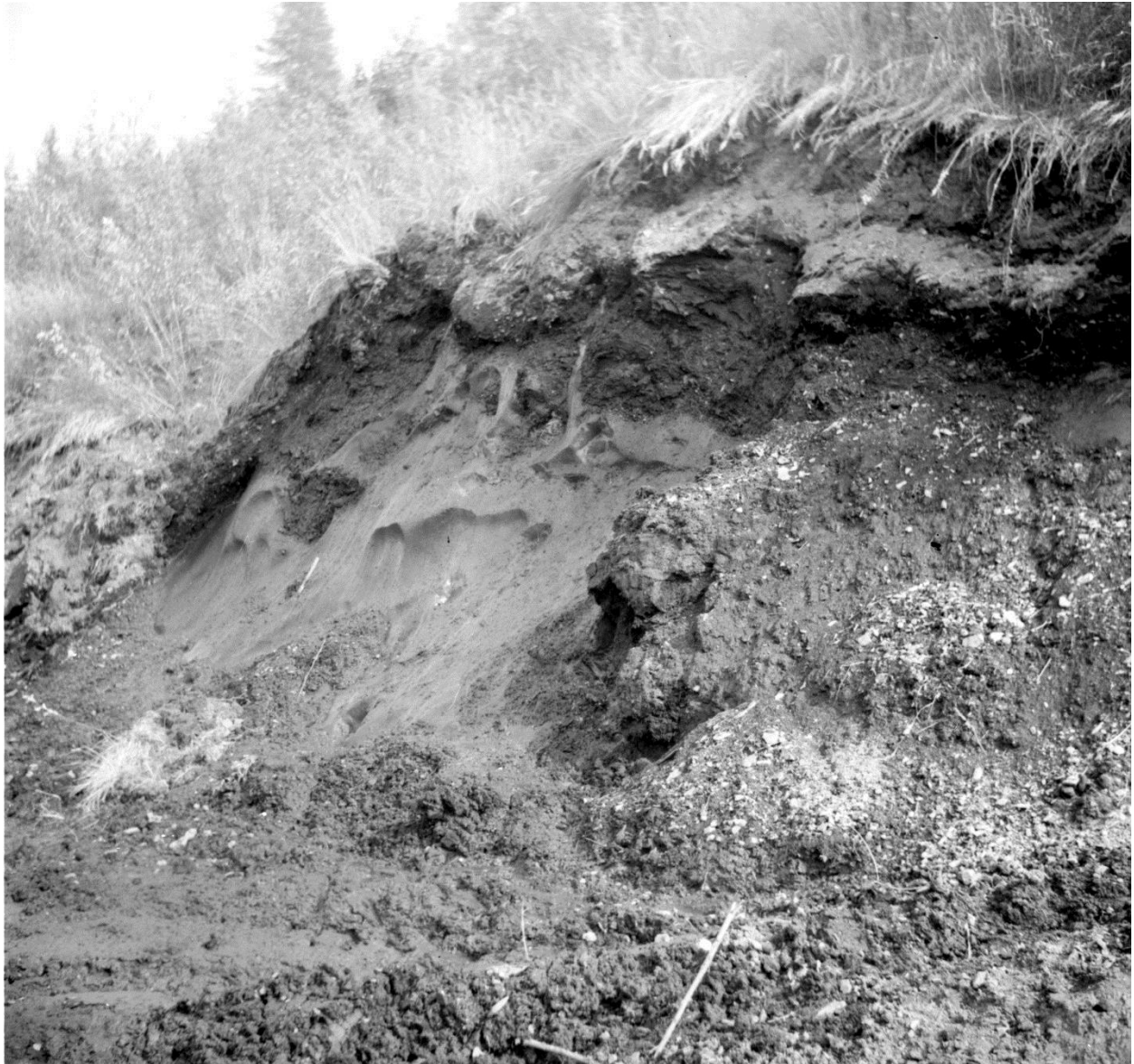
Рис. 4. Неокатанный щебень размером до 10–12 см во вмещающих сингенетические ледяные жилы склоновых отложениях в опорном криолитологическом разрезе позднеплейстоценового ледового комплекса в склоновых отложениях в долине ручья Утиное, правого притока р.Колымы
