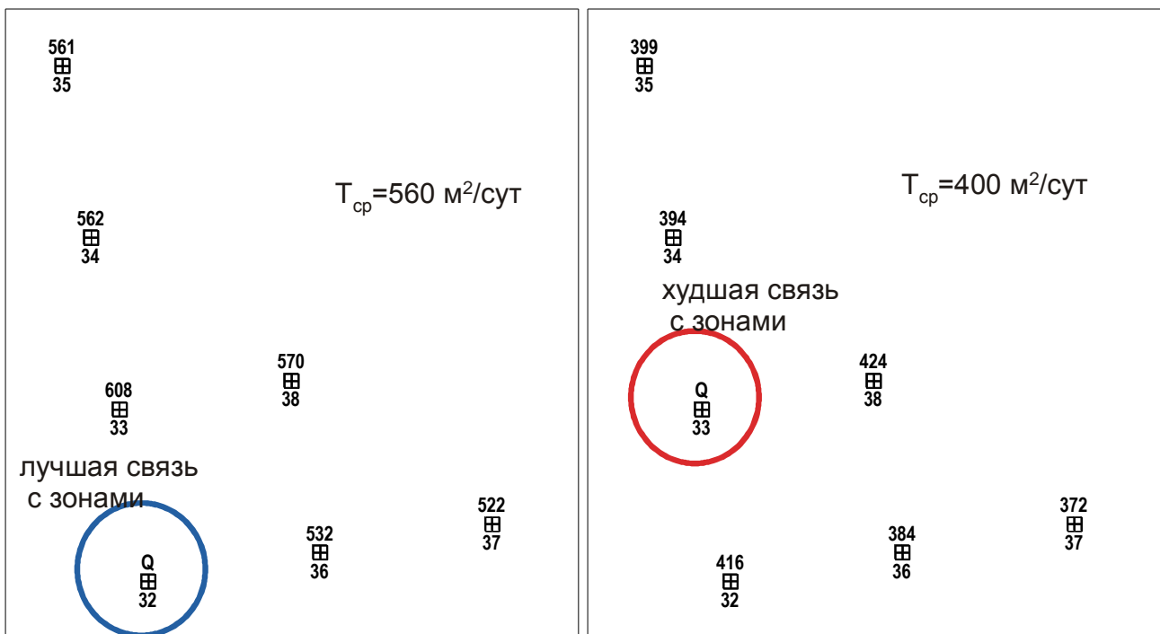
Рис. 8. Результаты кустовых наливов и явные области связи наблюдательных скважин и проницаемых зон (обозначения на рис. 7)
