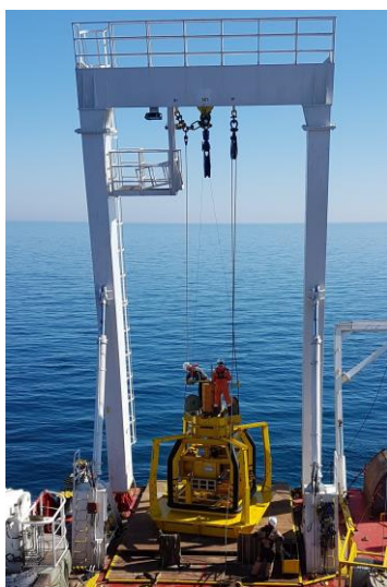
Рис. 1. Установка статического зондирования в конфигурации 15 тонн
