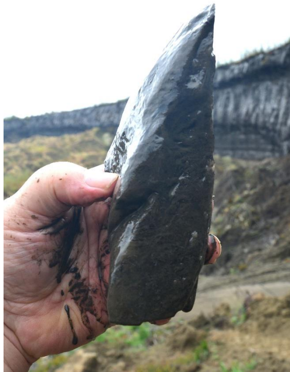
Рис. 13. Криотекстурные особенности сильнольдистого суглинка – древних таберальных отложений, вскрытых в нижней части Батагайского мегаоврага
