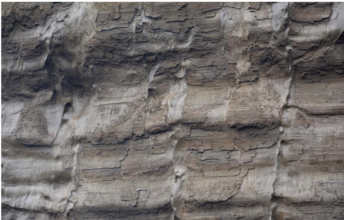
Рис. 5. Состав и сложение грунтов озерной или таберальной толщи, которая в виде горизонтально клина внедряется в едомную толщу Батагайского разреза
