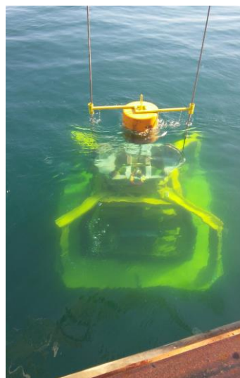
Рис. 1. Установка статического зондирования в конфигурации 15 тонн
