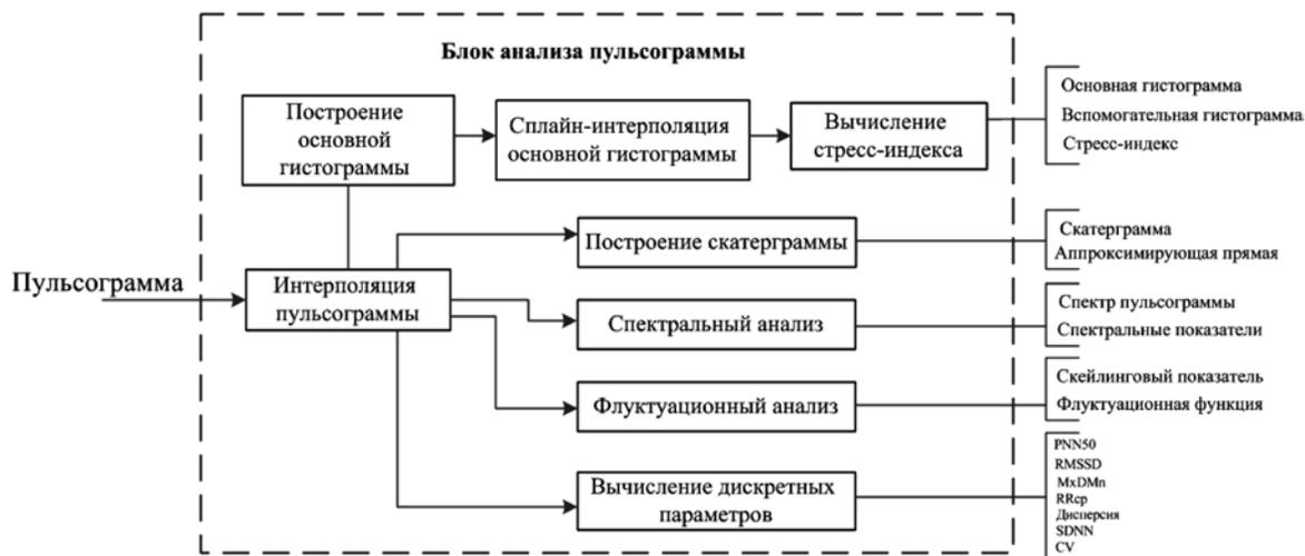
Рис. 7. Структурная схема анализа пульсограммы
