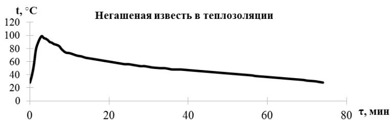
Рис. 3. Зависимость температуры нагрева от времени смеси на основе гашеной извести в теплоизоляции
