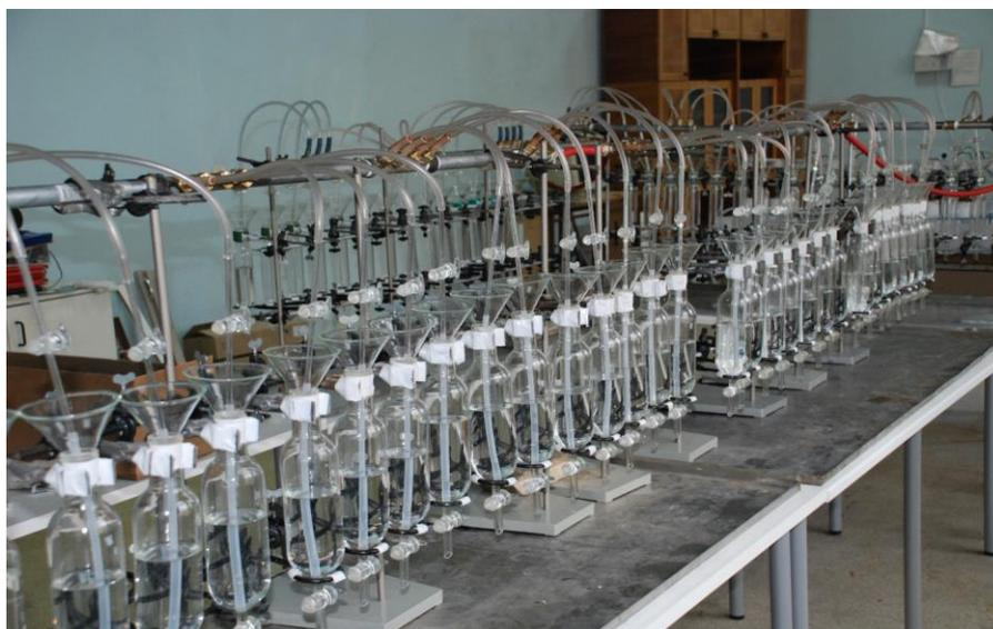
**Рисунок 1 – общий вид лабораторного 60-ти ступенчатого экстракционного каскада на основе стеклянных делительных воронок. Экстракционная часть каскада – воронки объемом 500 мл, промывная часть каскада – воронки объемом 250 мл**
