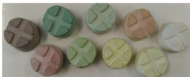
Рис.2. Составы затвердевшего цементно-песчаного раствора различных оттенков
