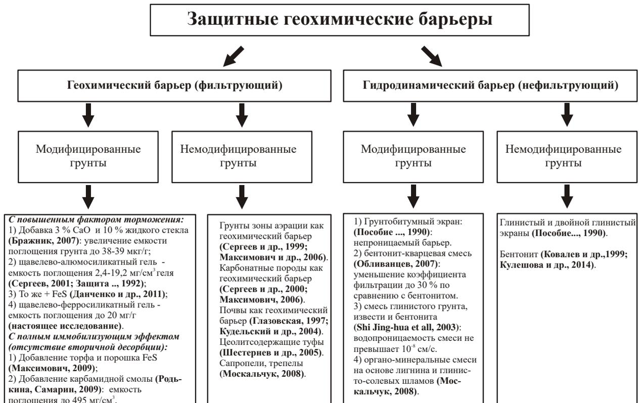
Рис.104. Защитные экраны, предлагаемые к использованию при эксплуатации полигонов складирования и захоронения отходов, содержащих тяжелые металлы (по [236], с сокращениями)
