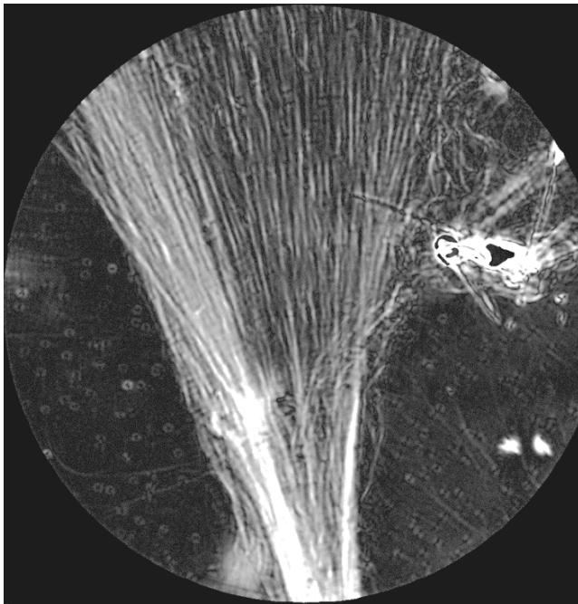
**Рис. 3.** Микрофотография, показывающая дискретную радиальную структуру струны. Видно большое количество субмикроскопических параллельных упругих струн, ее образующих.
