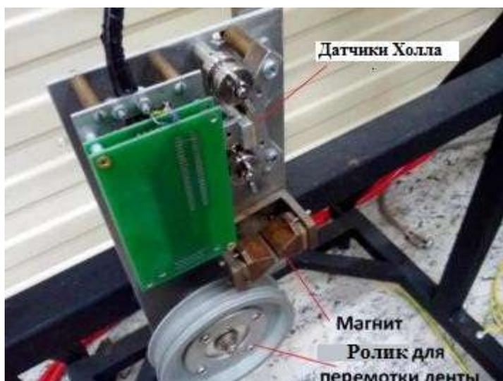
*Рис. 3.3.2. Установка “Суперскан”.*
