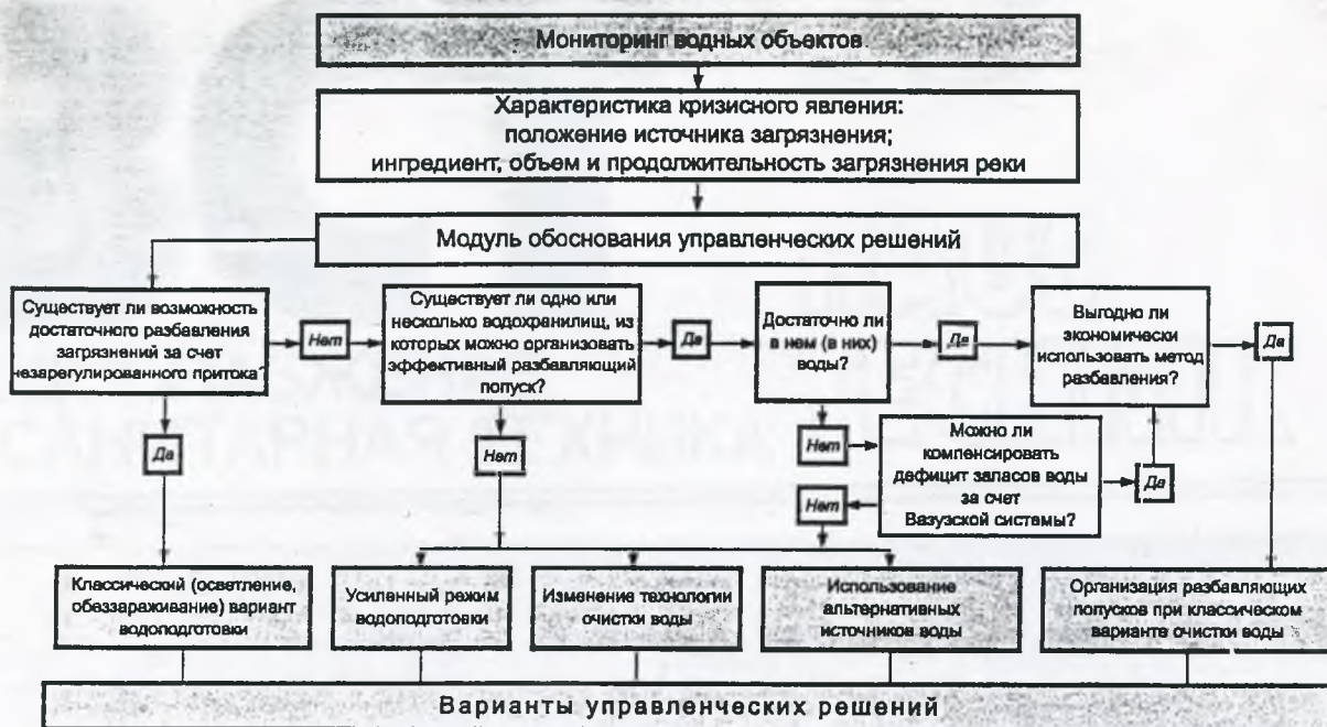
Рис. 3. Блок-схема выбора вариантов управленческих решений для обеспечения надежного водоснабжения столицы из Москворецкого водоисточника
