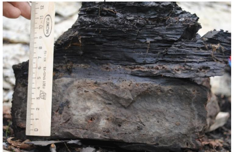
**Рисунок 6.** Переслаивание керогеново-карбонатных и кремнисто-карбонатных пород
