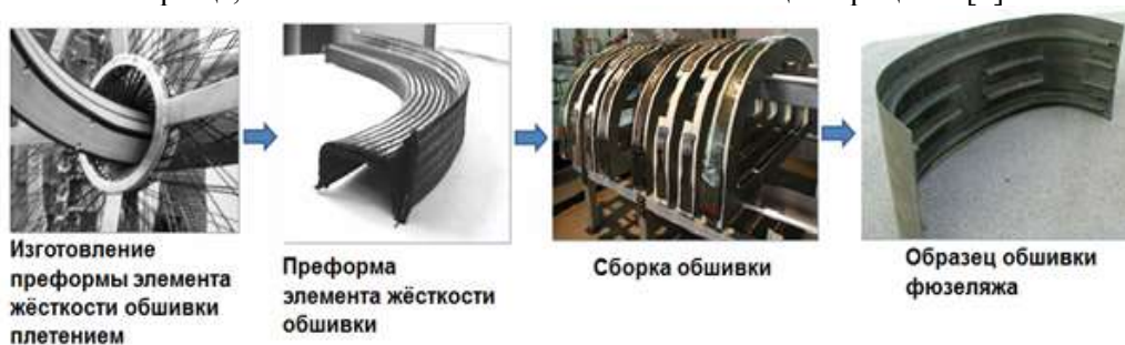
Рис. 1. Изготовление образца обшивки самолёта из ПКМ на основе плетёных преформ (EADS Deutschland Corporate Research Centre).
