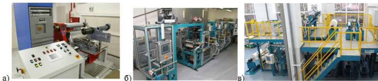
Рис. 1 а) Станок для получения микропластиков и препрегов Microsam MDW 100/2S-2 (Македония); б) Пропиточная линия для производства однонаправленных препрегов шириной до 600 мм Coatema LS-11 (Германия); в) Пропиточная линия для производства препрегов на основе углеродных лент и тканей шириной до 1200 мм Coatema BL-2800 (Германия) [12]
