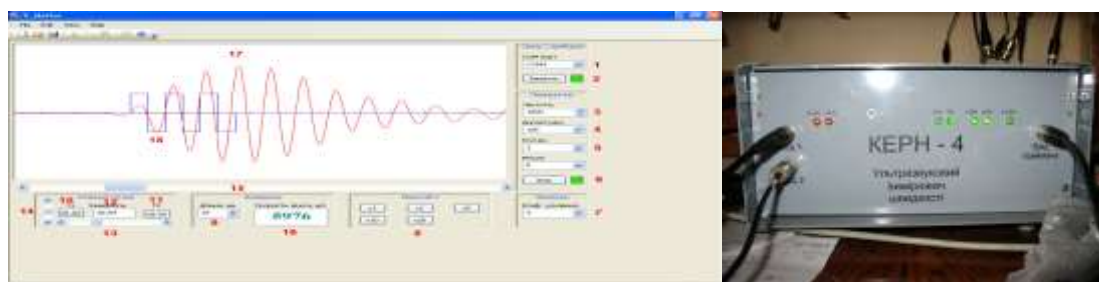
Рис. 1. Иллюстрация окна обработки данных измерений скоростей упругих волн эхо-импульсной методики на частоте f_{\parallel} \approx 1,11 МГц, f_{\perp} \approx 0,43 МГц и общий вид компьютеризованной установки КЕРН-4
