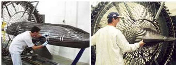
Рис. 3. Применение плетёных преформ при изготовлении фюзеляжа ракет (компания Fiber Innovations).
