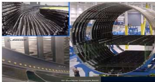
Рис. 2. Применение плетёных преформ при изготовлении элементов фюзеляжа Boeing 787 Dreamliner (компания A&P Technology).
