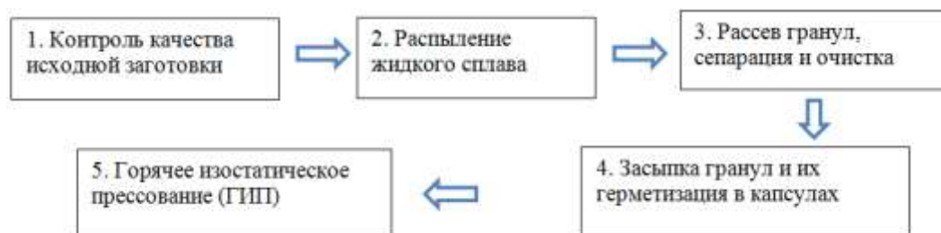
Рис. 1. Схема процессов технологии гранульной металлургии
