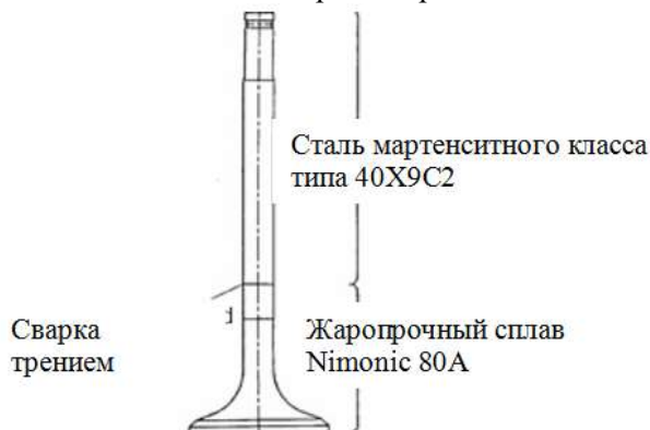
Рис. 1. Конструкция биметаллического выпускного клапана ДВС [1]
