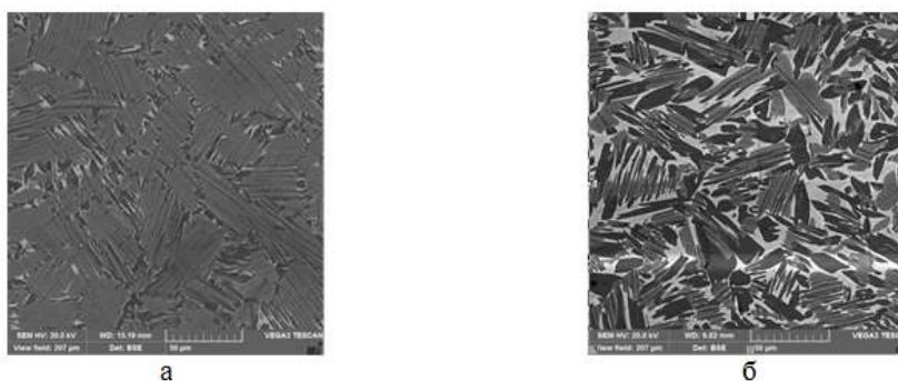
Рис. 2 Микроструктура сплавов TiNb (а) и TiNb+(б) после ГИП-обработки при 1250 °С и 170 МПа
