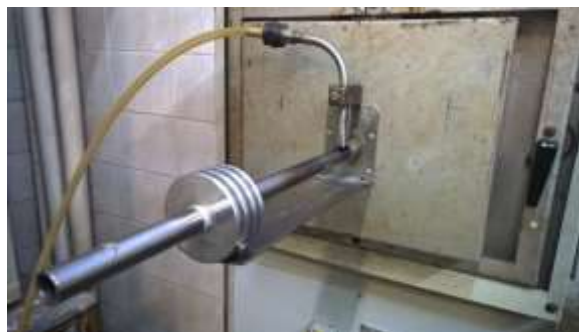
Рис.2 Устройство для нанесения «локального термоудара»
