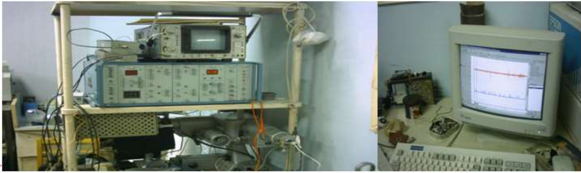
Рис. 2. Установка методики акустической эмиссии на частоте f_{\parallel} = 0,200 \pm 0,500 МГц \alpha = 70 дБ для измерения УЗ скоростей упругих волн.
