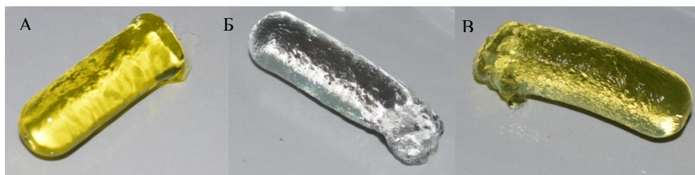
Рисунок 2. Фотографии: А-набухшего в воде криогеля, синтезированного сополимеризацией ДМА и 33 ; Б-набухшего в воде криогеля, синтезированного сополимеризацией ДМА и 34 ; В-набухшего в воде криогеля, синтезированного сополимеризацией ДМА и 35 .
