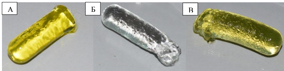
Рисунок 8. Фотографии: А - набухшего в воде криогеля, синтезированного сополимеризацией ДМА и 52 ; Б-набухшего в воде криогеля, синтезированного сополимеризацией ДМА и 53 ; В-набухшего в воде криогеля, синтезированного сополимеризацией ДМА и 54 .
