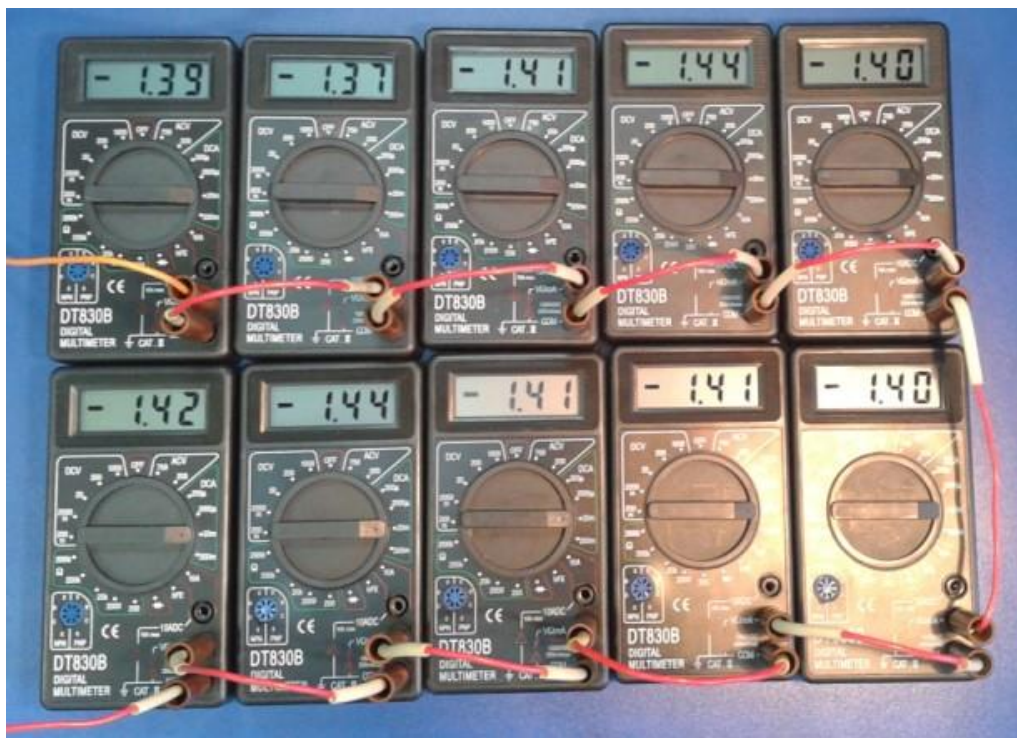
Рис. 3.10. Показания амперметров, соединенных последовательно.
