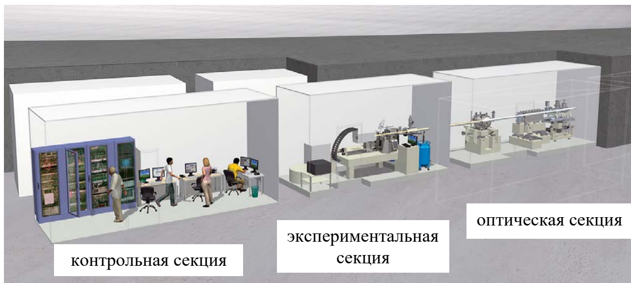
Рисунок 2.9 – Схема устройства экспериментальной линии в центре синхротронного излучения.
