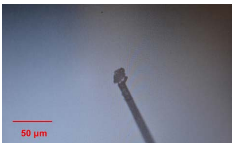
Рисунок 2.17 – Микрофотография фрагмента микроволокна полимера, захваченной зондом микроманипулятора.
