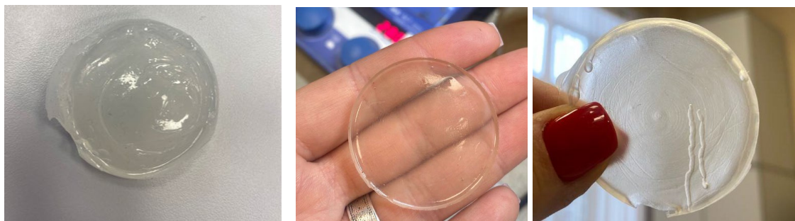
Рис.2. Полученные образцы отвержденной силиконовой резины.
