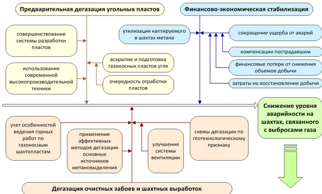
Рисунок 3.4.3 – Факторы, определяющие основные направления создания безопасных условий труда при подземной добыче угля
