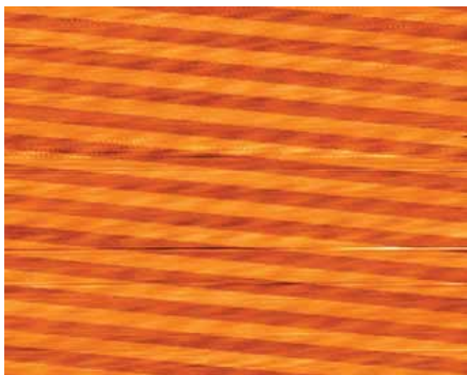
Рис.9. Топографическое изображение перемещения поверхности эталона нанометра по высоте Fig.9. Topographical image of vertical moving of surface of nanometer standard
