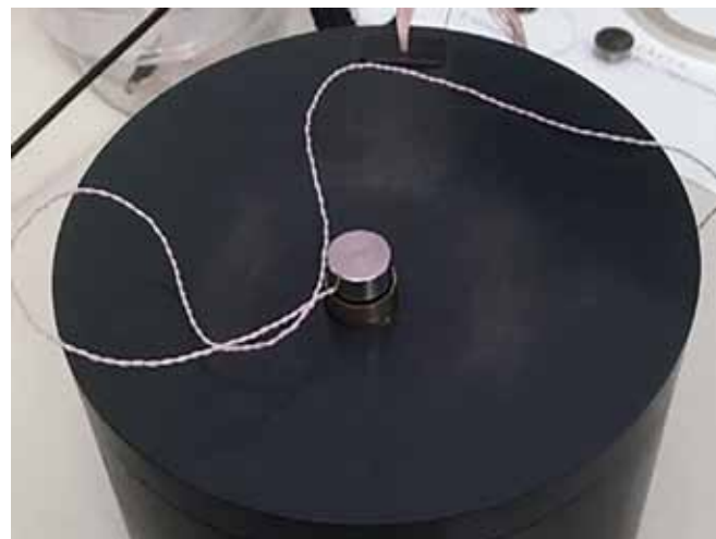
Рис.4. Эталон нанометра в металлическом корпусе для использования в СЗМ
