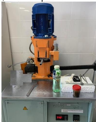
Рисунок – Четырехшариковая машина трения ЧМТ – 1
