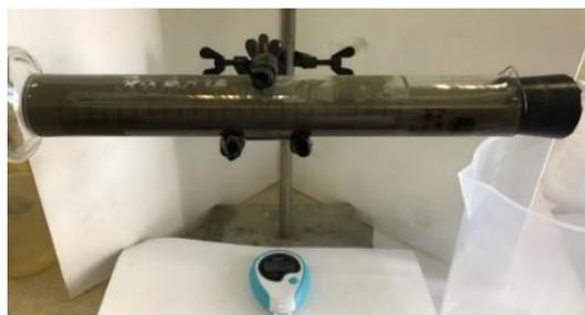
Рисунок 1 – Определение водоотделения в горизонтальных цилиндрах ПЦТ I-G-СС-1 с В/Ц 0,44
