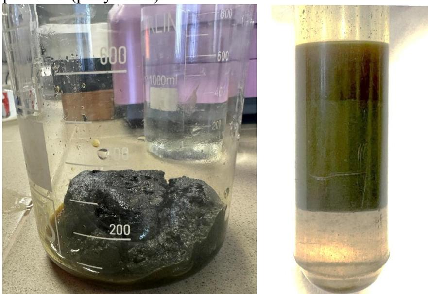
Рисунок 1 – Внешний вид промслоя до и после центрифугирования (4 цикла по 90 мин., 4500 об./мин.)
