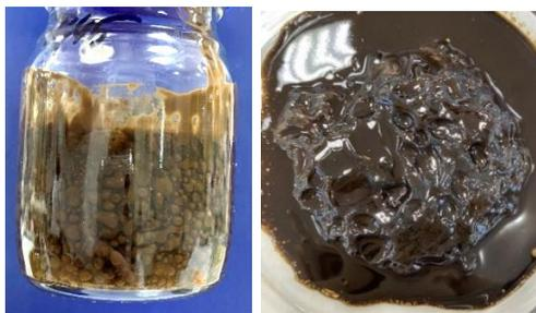
Рисунок – Внешний вид сшитой полимерной системы при контакте с нефтяной эмульсией
