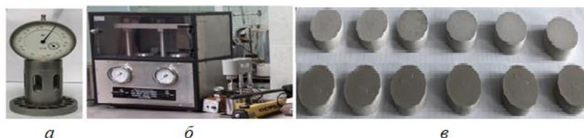
Рисунок 1 – Приборы для подготовки образцов и оценки набухания глин, образцы: а) адаптированная модель Жигача-Ярова, б) компактор, в) образцы для исследования (с содержанием мела и глины в пропорциях: 70 %:30 %; 50 %:50 %; 30 %:70 %)
