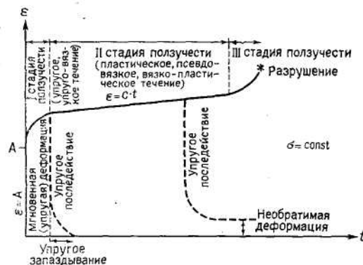
Рис. 4.8 (А). Обобщенная (типичная) кривая деформирования (по В. Ярошевскому, 1980)
