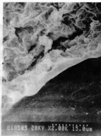
照片 2 蒙脱粘土( T=-1.5^{\circ}\text{C} C=0 )
