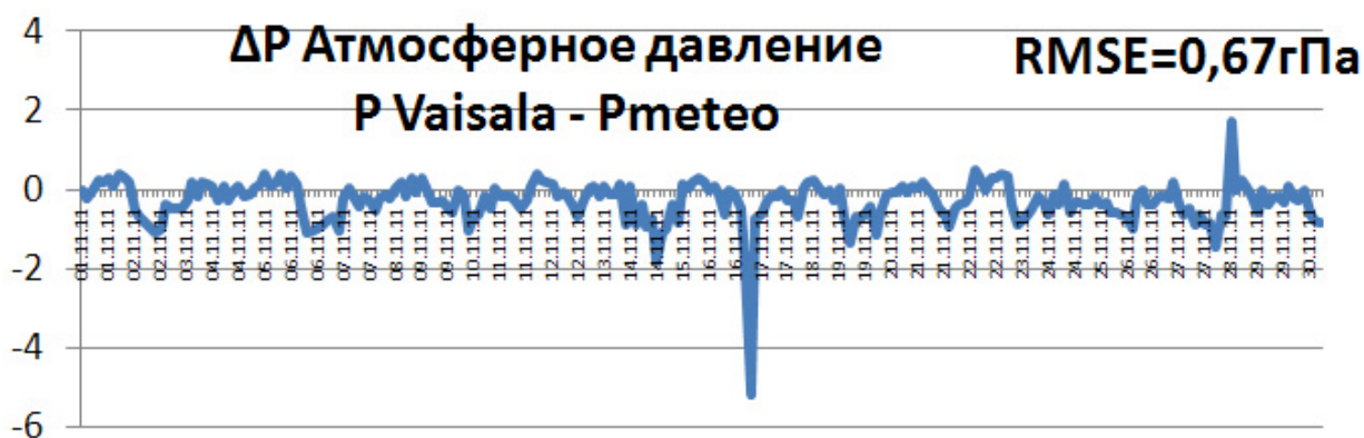
Рисунок 9.4. Сравнение двух способов измерения атмосферного давления (на графике изображена разность между показаниями АМС и стандартным способом измерения на метеорологических станциях)
