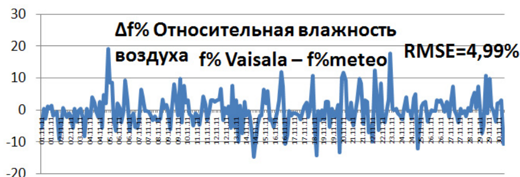
Рисунок 9.3. Сравнение двух способов измерения относительной влажности воздуха (на графике изображена разность между показаниями АМС и стандартным способом измерения на метеорологических станциях)
