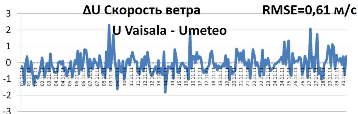
Рисунок 9.5. Сравнение двух способов измерения скорости ветра (на графике изображена разность между показаниями АМС и стандартным способом измерения на метеорологических станциях)
