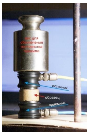
Рис. 2.10. Взаимное расположение датчиков и образца
