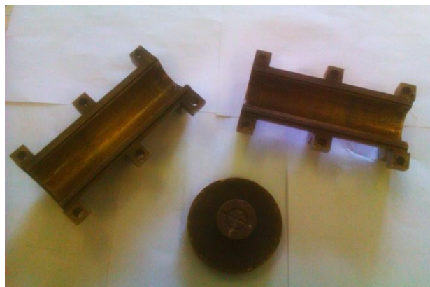
Рис. 2.2. Формы для изготовления образцов модельных глинистых грунтов
