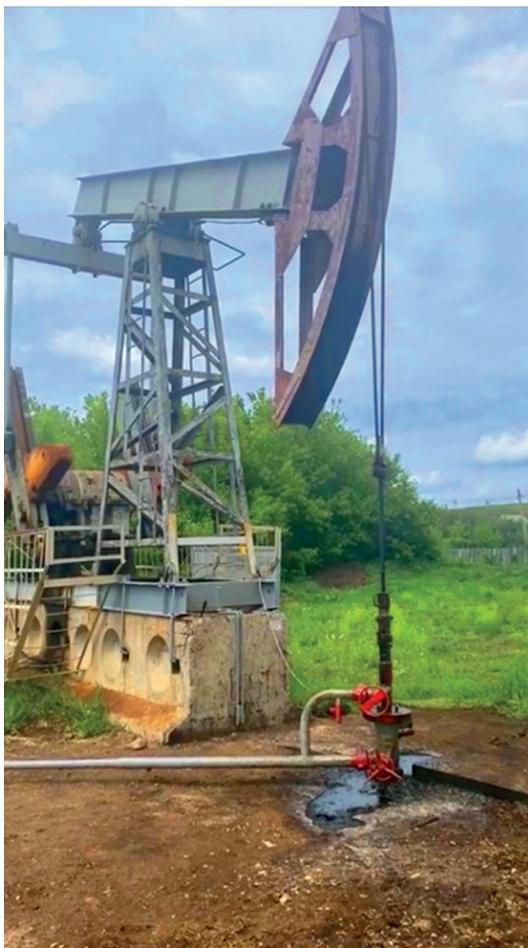
Рис. 2. Утечка пластового флюида из-за изношенности устьевого сальника (СУСГ) на одном из месторождений Татарской НГО
