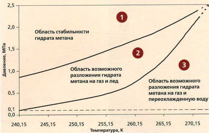
РИС. 2. ОСОБЕННОСТИ РАЗЛОЖЕНИЯ ГИДРАТА МЕТАНА ПРИ ПЕРЕВОДЕ СИСТЕМЫ ИЗ ОБЛАСТИ СТАБИЛЬНОСТИ 1 В ОБЛАСТИ 2 И 3
