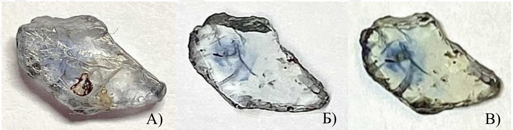
Рис. 14 (А, Б, В) А – исходный кристалл бледноокрашенного ювелирного корунда; Б – после обработки; В – после облучения [4];
