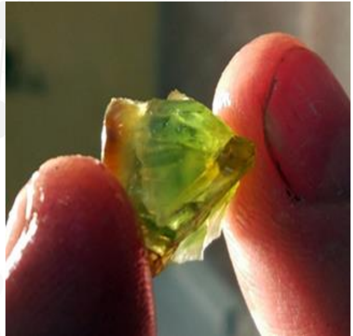
Рис. 6 Фрагмент нодулы хромсодержащего после двухстадийной термообработки [2];
