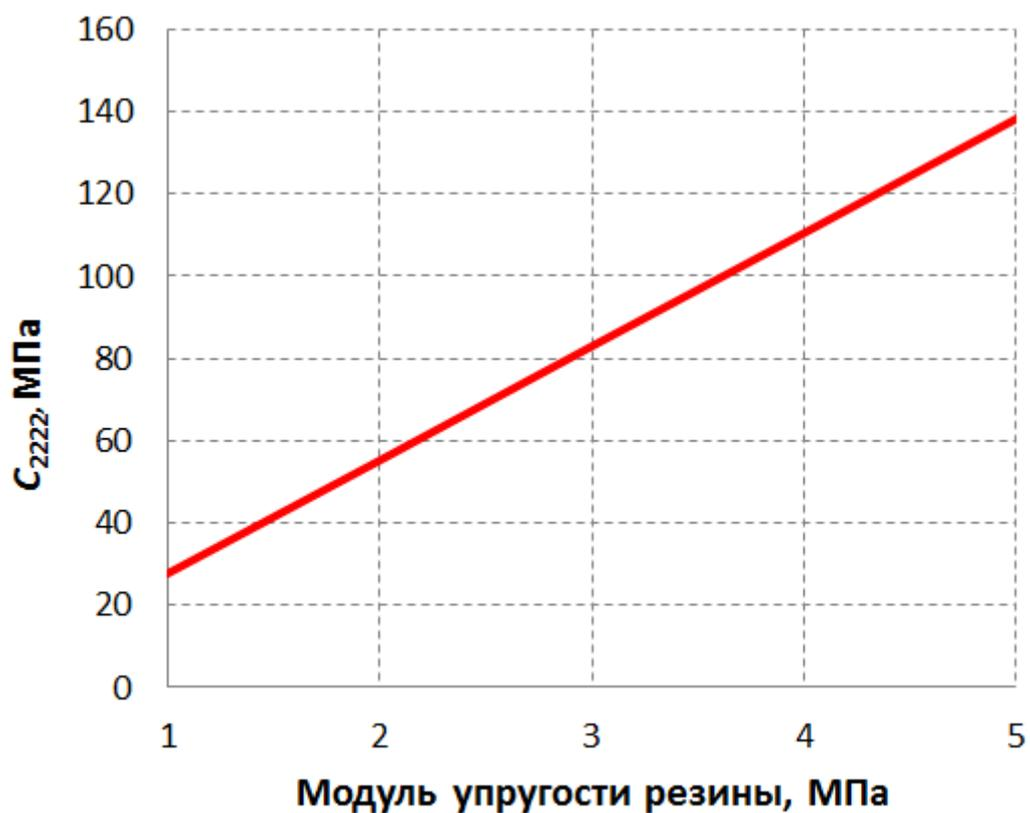
Рисунок 3. Зависимость коэффициента  $C_{2222}$  эффективного материала от модуля Юнга резины.
