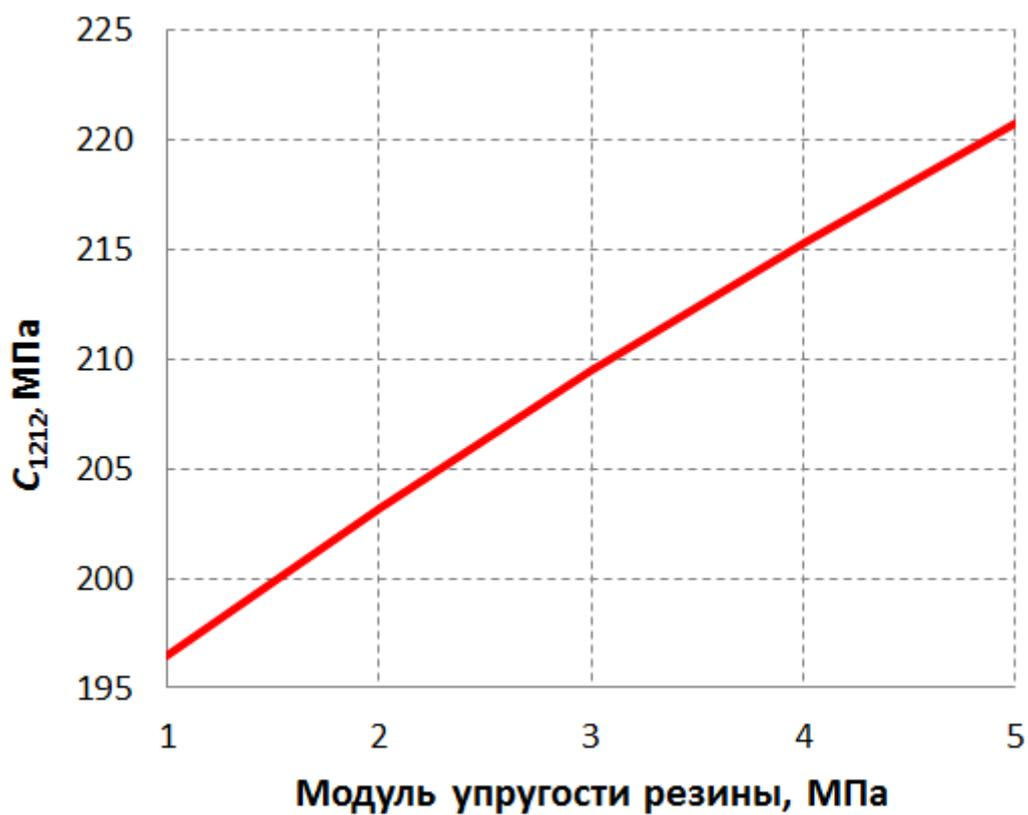
Рисунок 4. Зависимость коэффициента  $C_{1212}$  эффективного материала от модуля Юнга резины.
