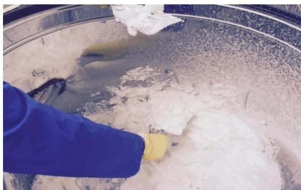
Рис. 2. Выемка свежеприготовленной пены на основе СДКП
