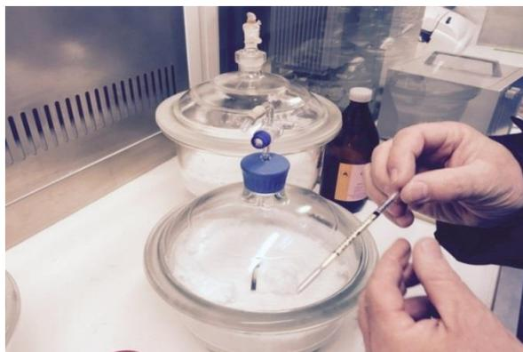
Рис. 4. Определение концентрации АХОВ по изменению окраски наполнителя индикаторной трубки
