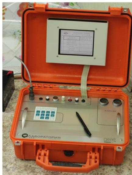
Рис. 1. Внешний вид сейсмической станции «Синус»
