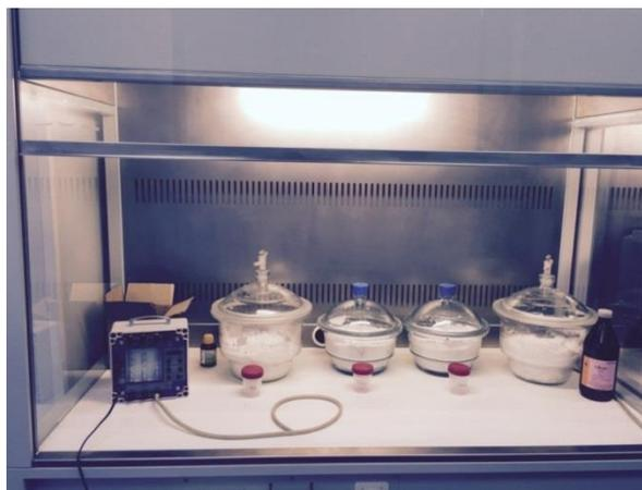
Рис. 3. Исследуемые образцы АХОВ и СДКП в эксикаторах, помещенные в вытяжной шкаф
