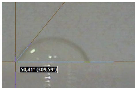
Рис. 3. Изображение капли в процессе определения краевого угла смачивания поверхности напечатанного образца с модельным рисунком 5_Octogram из полимера PETG
