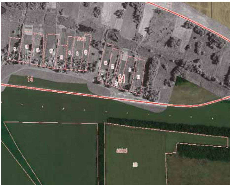
Рис. 3. Пример совместного отображения материалов космической и аэрофотосъемки с материалами кадастрового деления. Ростовская обл.
