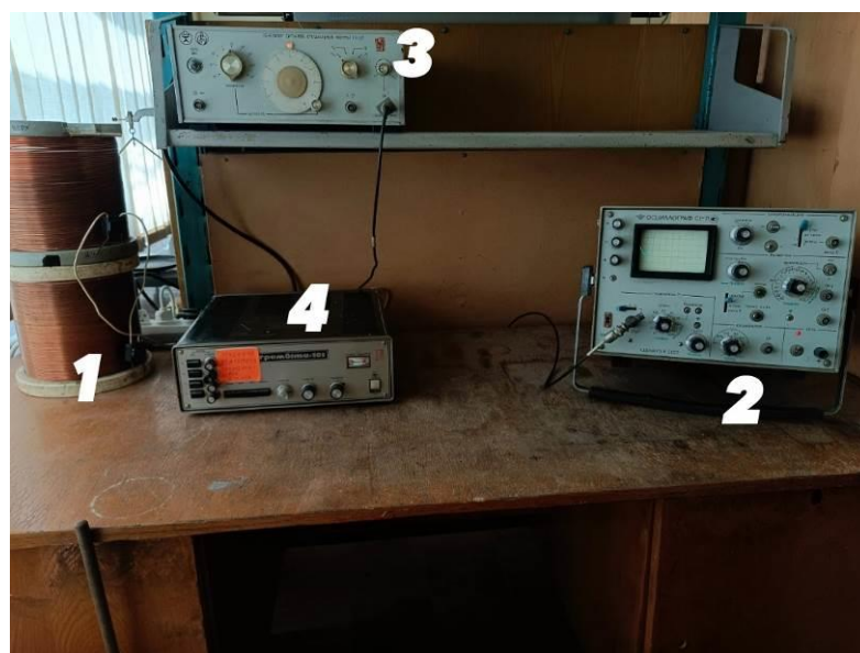
Рис. 1. Внешний вид установки по обработке семян растений переменным магнитным полем
