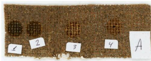
Рис. 1. Фотография образца холста и различных зон облучения: 1) время обработки 100 с; 2) время обработки 80 с; 3) время обработки 35 с; 4) время обработки 44 с.
