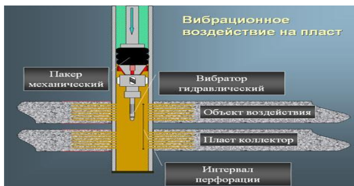
Рис. 6 Вибрационный метод увеличения нефтеотдачи [4].
