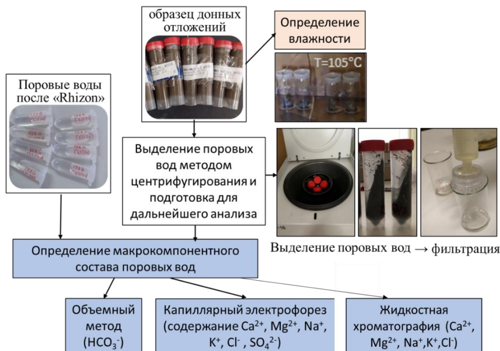
Рис. 2 Методика извлечения и анализа поровых вод донных осадков Баренцева и Карского морей.
