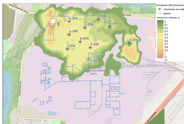
Рис. 1 Положение и мощность линзы нефтепродуктов на 2032 г., при действующей системе дренажа, усиленного откачивающими скважинами.
