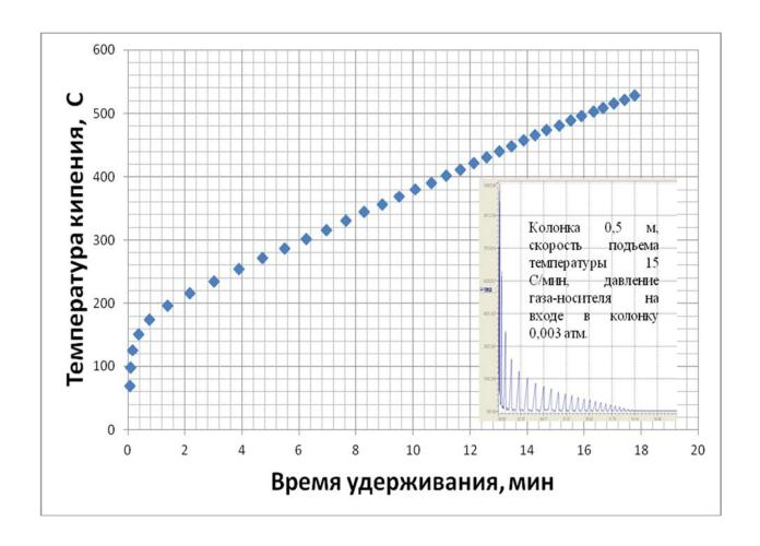
Зависимость времени удерживания от температуры кипения углеводородов для колонки с I = 4,0 м
