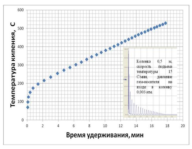
Зависимость времени удерживания от температуры кипения углеводородов для колонки с I = 0,5 м
