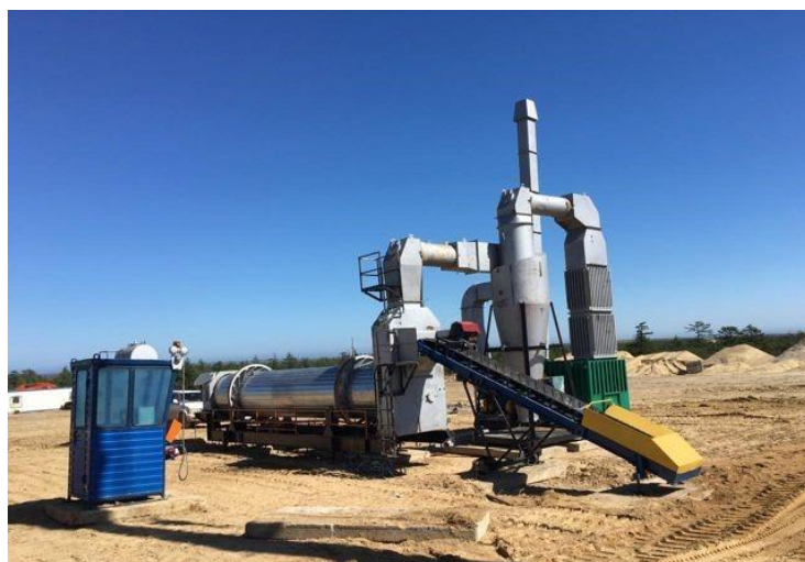
Рис. 1. Установка для переработки и утилизации замазученных грунтов (УЗГ-1М)
