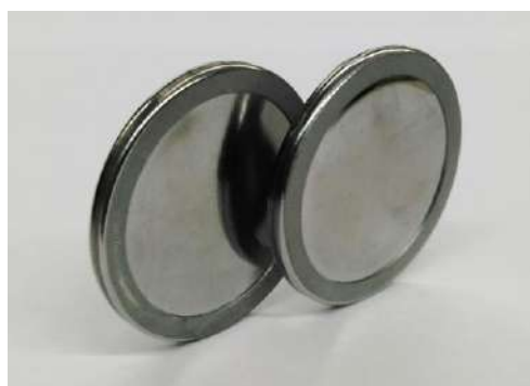
Рисунок 2.2-30. Мишень металлического тория в ниобиевой оболочке для наработки производственных количеств ^{225}\text{Ac} ; а – до облучения; б – после облучения.
