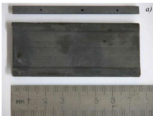
Рисунок 2.1-11. а – графитовая оболочка с крышкой (сверху); б – плавка Sb в процессе заполнения оболочки.
