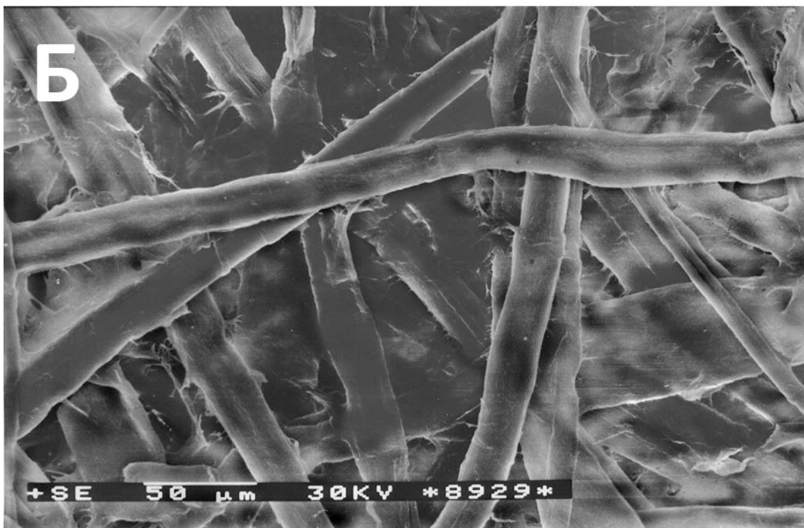
Рисунок 1.1. Электронная микрофотография поверхности целлюлозного фильтра “синяя лента” (А) и такого же фильтра, обработанного парафином (Б).
