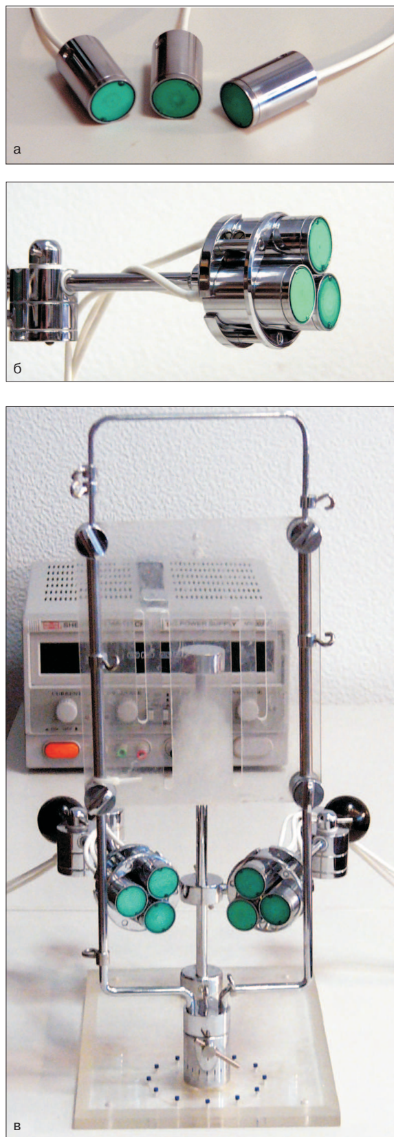
Рис. 1. Установка для локальной ультразвуковой гипертермии опухолей УСДТ-м: а) автономный облучатель, б) рабочий блок излучателей, в) установка в сборе
